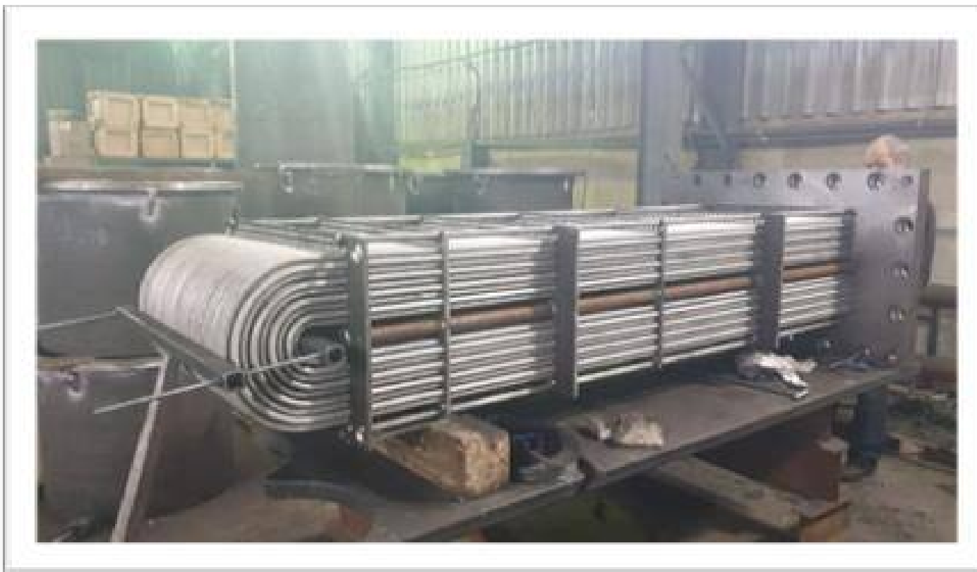
Модернизация трубного пучка сальникового подогревателя ПС-115 блока 4 Ириклинской ГРЭС
