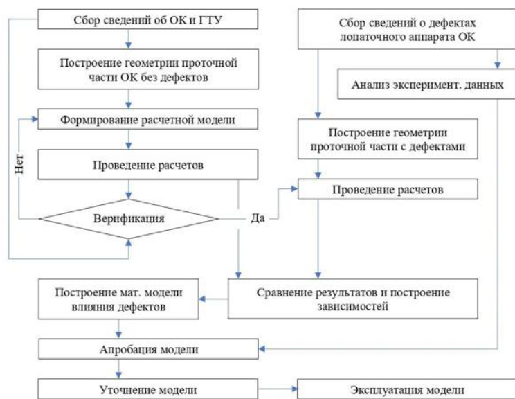
Рисунок 1 - Алгоритм формирования модели по оценке техсостояния ГТУ
